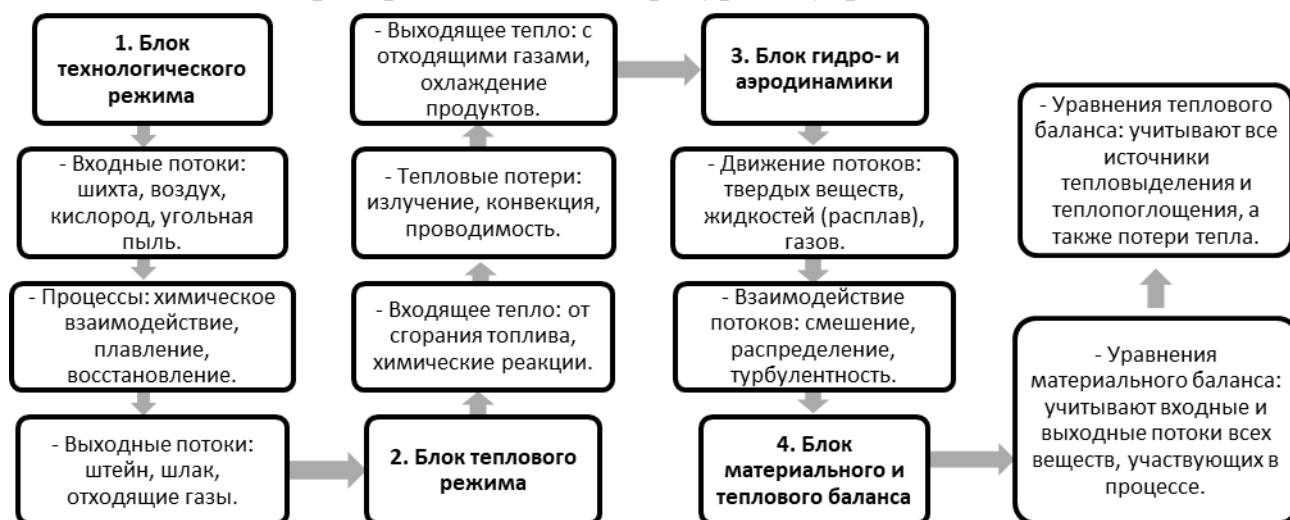
Рисунок 3.1 – Описание процессов, протекающих в плавке Ванюкова
